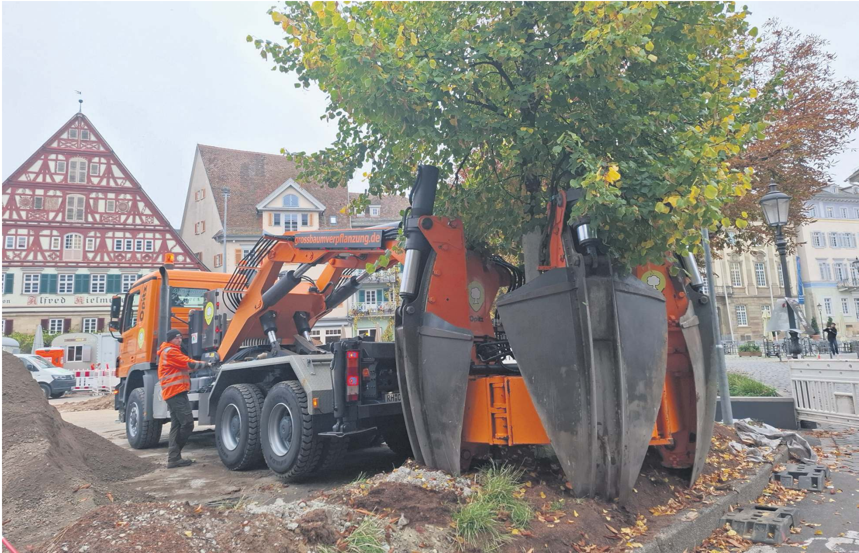
Mit fünf hydraulischen Spaten wurde die Linde auf dem Esslinger Marktplatz behutsam aus dem Erdreich geholt.
